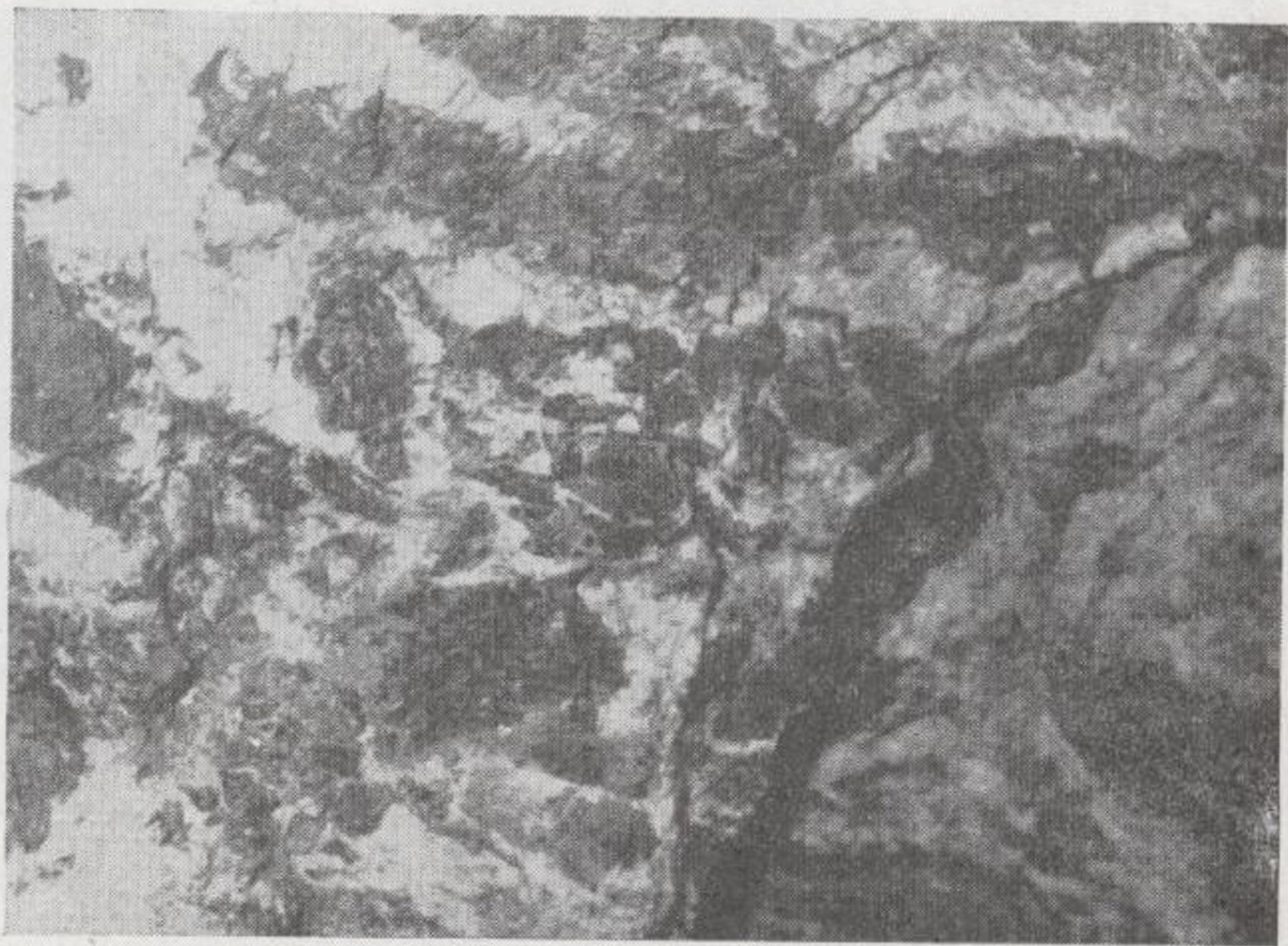
Dolomia acebrada gruesa y fluorita. La distorsión llega a brechificar la zona inferior, donde hay mayor acumulación en fluorita. (Labores antiguas de Maldonado Nuevo.)
